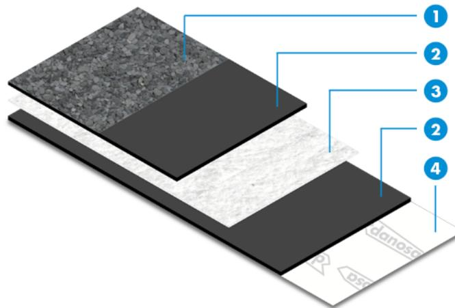
Despiece de lámina asfáltica
